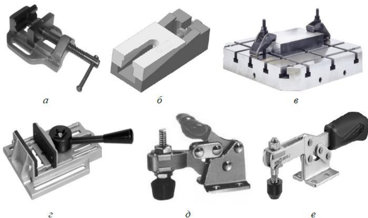
Рис. 4.5. Примеры использования винтовых (а), клиновых (б), рычажных (в), эксцентриковых (г), шарнирно-рычажных (д, е) механизмов
